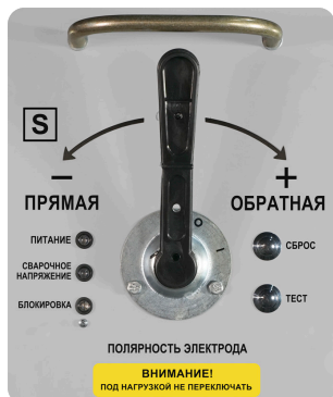
Панель управления блоком БСН
