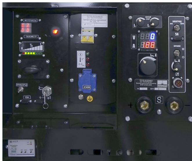
Агрегат предназначен для дуговой сварки штучным электродом и для питания электроинструмента (освещения) на открытом воздухе в полевых условиях.
