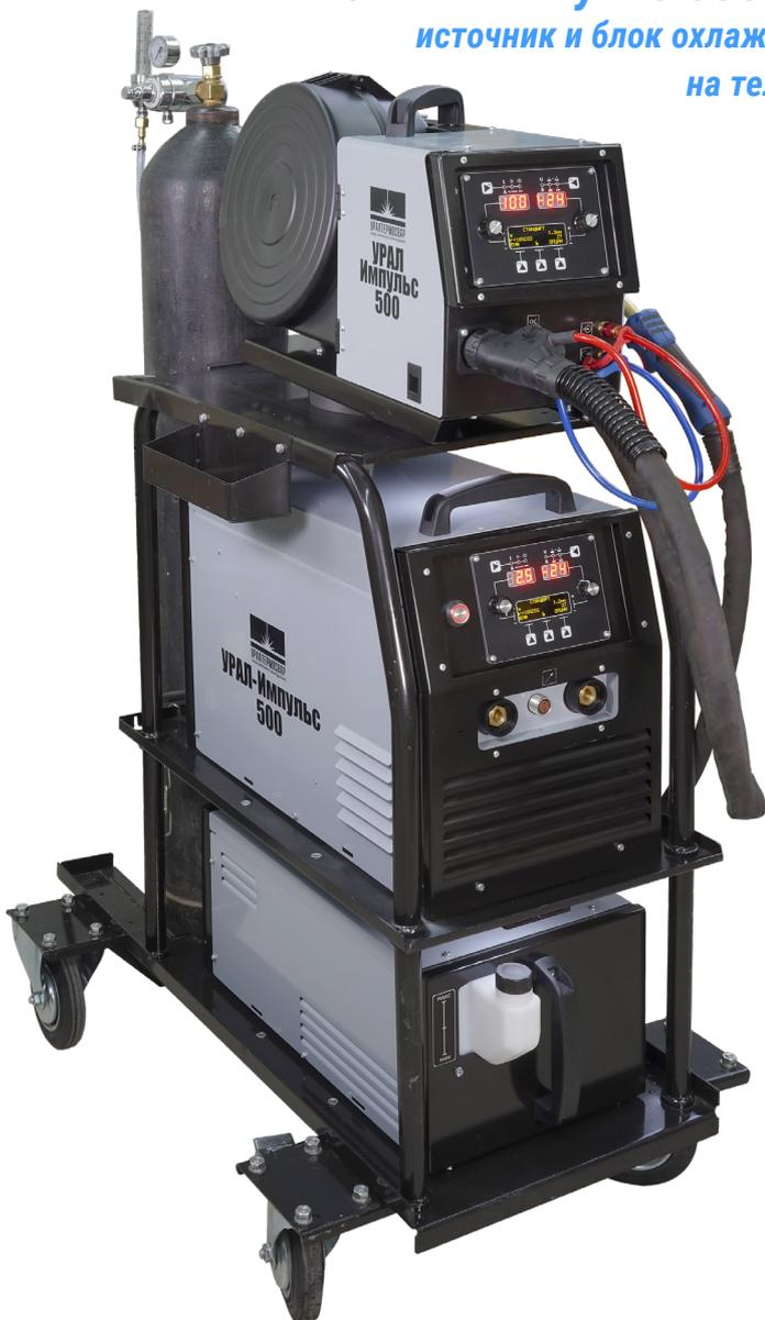
в сварочную ванну, обеспечивать высокую стабильность переноса электродного металла и качественную структуру сварного шва. Целесообразно применять при сварке изделий из тонколистового металла, на вертикальных швах, где обеспечивается повышенная скорость сварки, при сварке алюминия и его сплавов;
