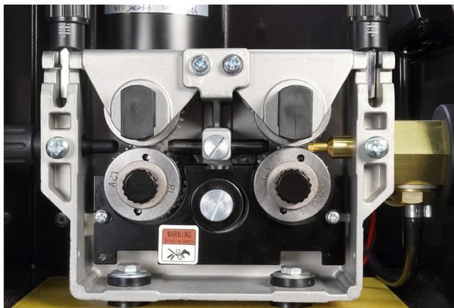
УРАЛ-Импульс 500 оборудован четырёх роликовым механизмом подачи сварочной проволоки.
