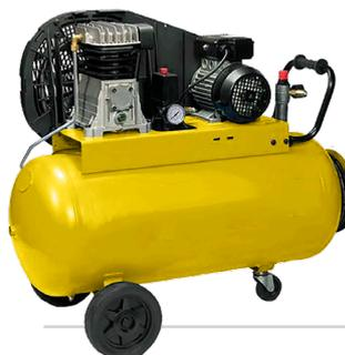
Компрессор: производительность- 457 л/м объем ресивера- 90 л. давление- 10 бар мощность- 3 кВт напряжение- 380 В.
