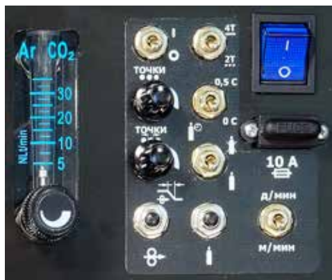
внутренняя панель управления ПДГО-512 УРАЛ
